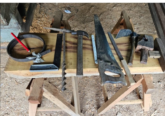
Ferramentas para construção do carro de boi.
