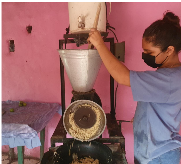
Figura 16 : Moinho mediador onde o milho pe transformado em massa
