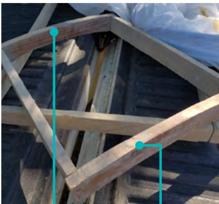
O molde da placa de parede pode ser feito de madeira ou metal e tem uma ligeira curvatura em seus lados menores, permitindo que as paredes tenham uma forma redonda.
